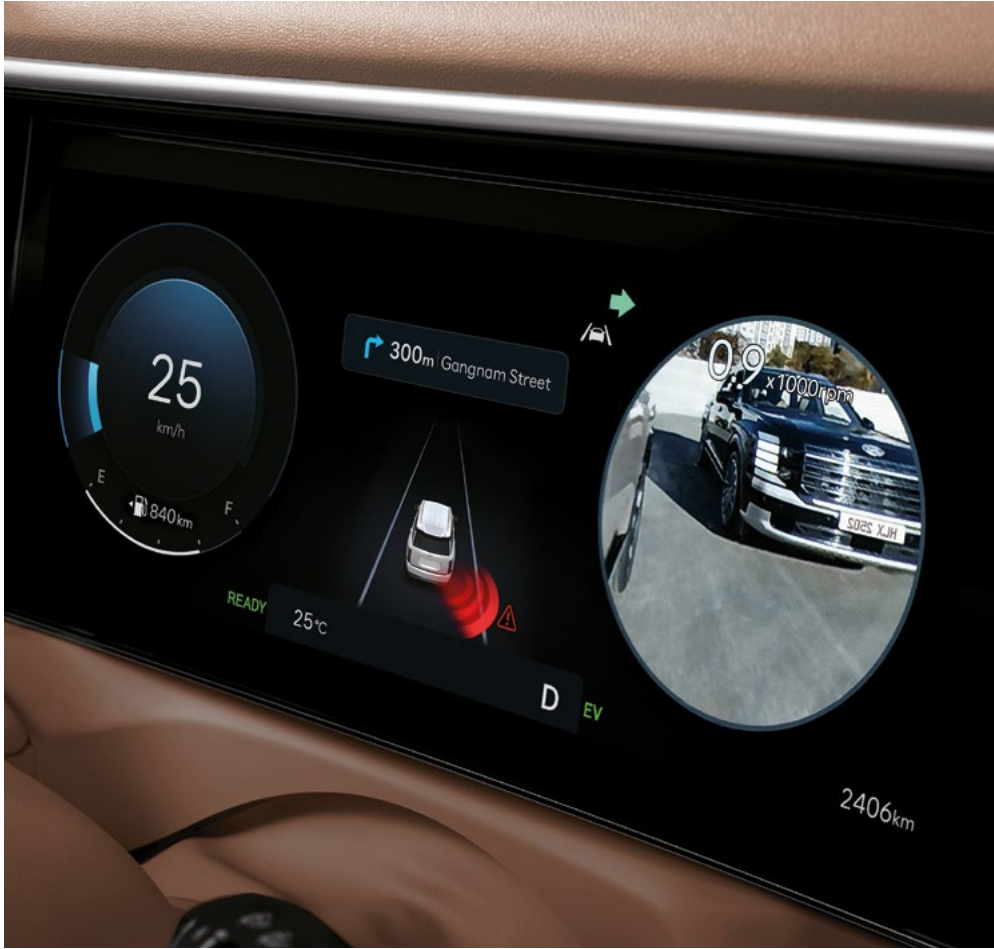
Система відеомоніторингу «сліпих» зон (BVM)
