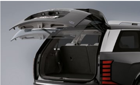
Електропривід дверей багажного відділення (з можливістю налаштувати висоту відкриття)
